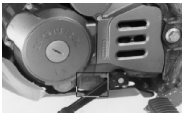
(2) O número de série do motor está gravado na parte inferior da carcaça esquerda do motor.
